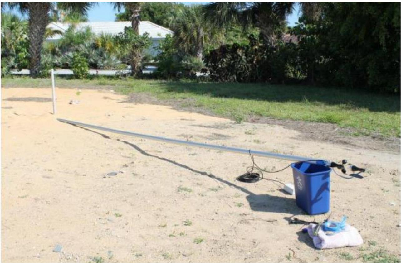
Como o data logger não está conectado, consegui ampliar a extensão do cabo. Como não tinha certeza se isso poderia causar problemas, liguei para o serviço técnico da PCE. Eles me disseram que a extensão poderia ser ampliada até 15 m. Dito e feito. Alonguei o cabo e conectei-o à eletrônica, seguindo as instruções do manual do usuário.
