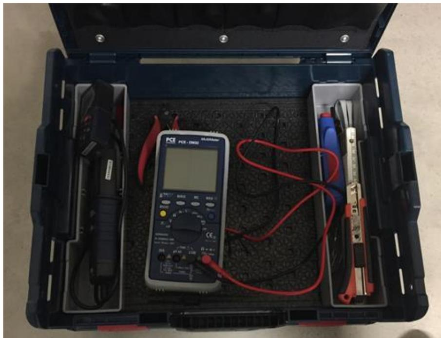
Além das funções típicas de multímetro, o PCE-DM 32 tem uma interface serial que me permite transferir os valores medidos para o PC. Em comparação com outros multímetros nessa faixa de preço, o multímetro oferece uma tela muito grande na qual, além dos valores medidos, também mostra em quais soquetes os cabos de teste devem ser inseridos.
